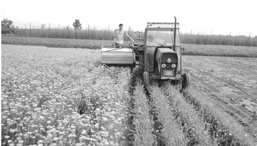
Slika 3. Mašina sa virtualnim rotirajućim češljem pri branju cvasti nevena
