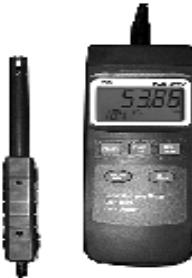
**Psihrometar** (sl. 5) je uređaj koji se u plastenicima koristi za istovremeno merenje temperature i vlažnosti vazduha. Ukoliko se u plateniku vrši kontrola temperature i relativne vlažnosti vazduha grejanjem i ventilacijom, neophodan je kao deo opreme.
