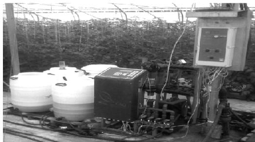
Sl. 18. Kontrolna jedinica FX 200 (model 1Z2V30) sa mikser mašinom, ventilima i senzorima,Zeleni hit 2007.
