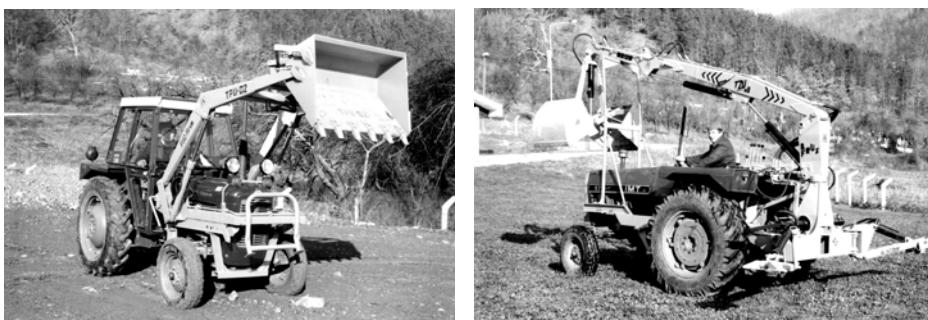
Slika 2. Traktorski uređaji tipa TPU i TZU
