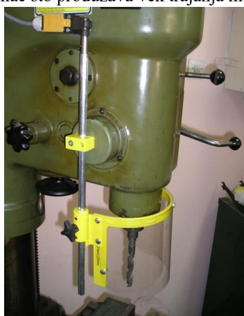
Slika 3. Detaljan izgled zaštitnika oko reznog alata (burgije) od pleksiglasa sa mikroprekidačem Figure 3. The appearance the safety guard around the cutting tool (drill) made of plexiglas with a microswitch
