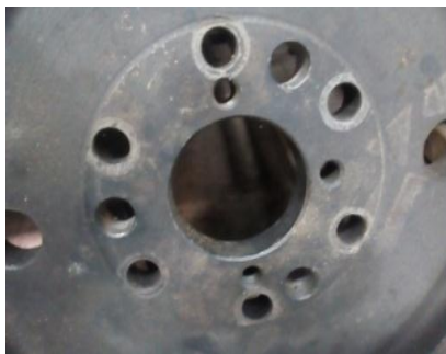
Slika 31. Zamajac 80254/174684 -pogled na otvore za klinove i zavrtnje kolenastog vratila
