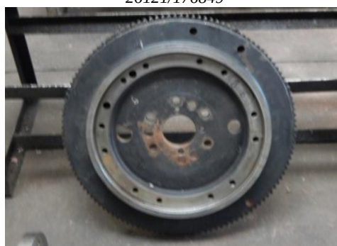
Slika 20. Zamajac 23645/17817 -pogled na zamajac sa strane kojom se spaja sa kolenastim vratilo, Figure 20. Flywheel 52714/17495 -view of the flywheel from the side that connects to the crankshaft
