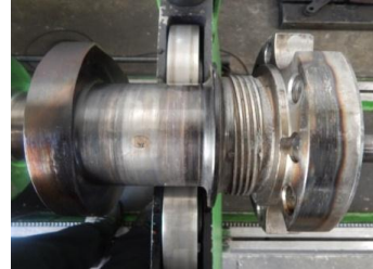
Slika 34. Kolenasto vratilo 11682/17445 - pogled na deo kolenastog vratila sa pokretnim masama
