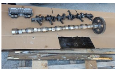
Slika 3. Bregasta osovina, osovinica klackalica sa klackalicama i nosač rolnica motora Caterpillar tip 3126 -celokupan izgled
