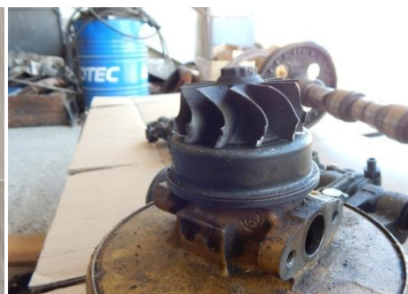
Slika 22. Oštećene lopatice turbine motora drobilice za drvo
