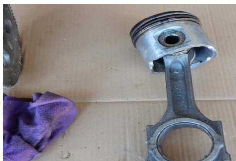
Slika 21. Klip i klipnjača šestog cilindra motora drobilice za drvo
