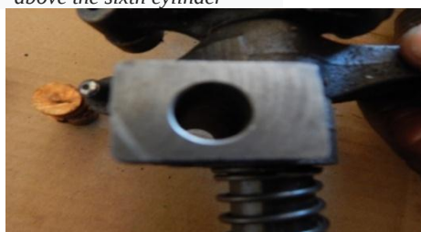
Slika 9. Oštećena treća površina nosača klackalica koja dodiruje glavu iznad šestog cilindra, motora proizvodnje Caterpillar 3126
