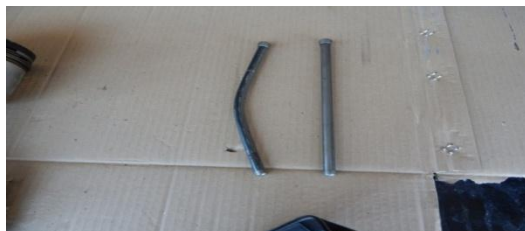
Slika 19. Deformisana i nedeformisana šipka podizača izduvnog ventila na šestom cilindru motora
