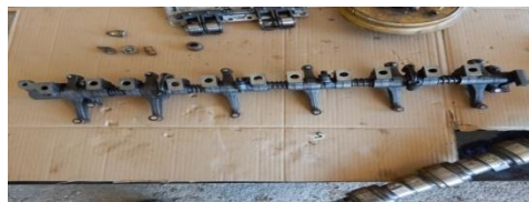
Slika 8. Površine nosača klackalica koje dodiruju glavu motora proizvodnje Caterpillar
