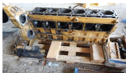
Slika 4. Blok pogonskog motora proizvodnje Caterpillar tip 3126 - pogled sa boka
