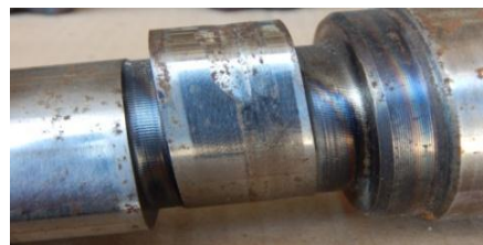
Slika 6. Bregasta osovina motora Caterpillar 3126- oštećenje brega šestog izduvnog ventila-pogled odozgo
