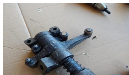
Slika 12. Klackalica koja dodiruje glavu iznad šestog cilindra motora drobilice za drvo - povećan zazor koji omogućuje i aksijalno pomeranje i klaćenje klackalice šestog izduvnog ventila
