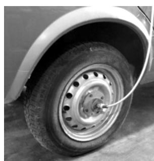
Sl. 3. Detalj davača ugaone brzine točka.
