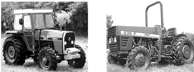
Sl. 3, 4. Kabina i zaštitni ram na traktorima za povećanje bezbednosti u radu [20]
