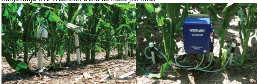
Slika 3. Merenje vlažnosti zemljišta, postavljanje, očitavanje i daljinska komunikacija, [22]. Figure 3. Soil moisture measurement, installation, reading and remote communication, [22].
