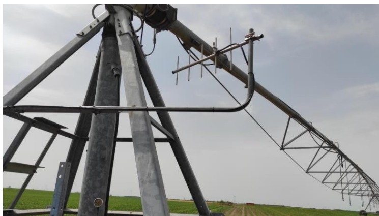
Slika 1. Antena za daljinsko upravljanje korišćenjem radio signala na mašini za navodnjavanje.
