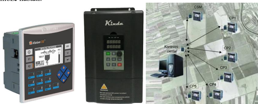
Slika 2. Frekventni regulator, PLC kontroler i SCADA sistem, [19].
