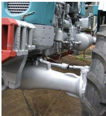
Slika 1. Novougrađeni pogonski most
