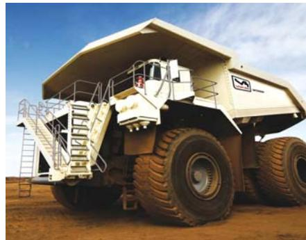
Slika 2. Unit Rig (Terrex&Co.), damper sa elektro pogonom [10]
