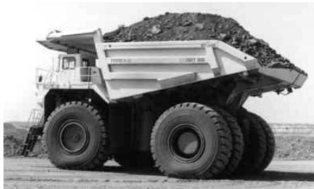
Sl. 5. Unit Rig, prvi damper sa elektro pogonom [19]
